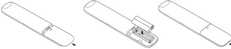
**ACHTUNG:** Es besteht Brand- oder Explosionsgefahr, wenn die Batterie durch einen falschen Typ ersetzt wird.
