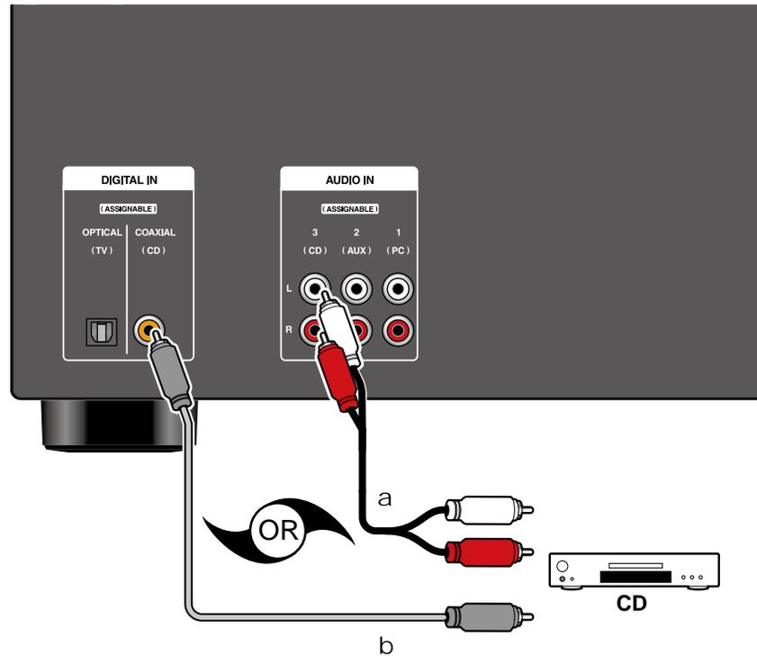
Voici un exemple de raccordement avec un composant audio. Raccordez un lecteur CD à l'aide d'un câble coaxial numérique ou d'un câble audio analogique.
