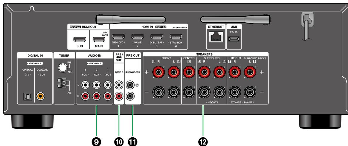
9. **Prises AUDIO IN** : Entrée des signaux audio composante AV avec un câble audio analogique.
