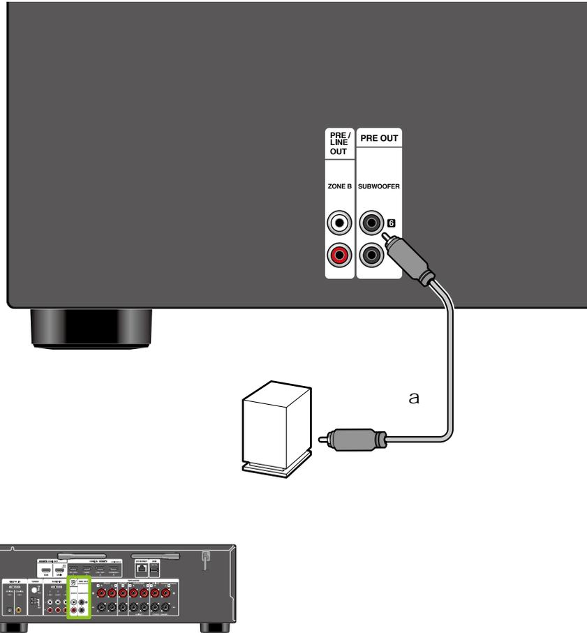
Raccordez un caisson de basse sous tension à cet appareil avec un câble pour caisson de basse. Il est possible de raccorder jusqu'à deux caissons de basse sous tension. Le même signal est reproduit par chacune des prises SUBWOOFER PRE OUT.
