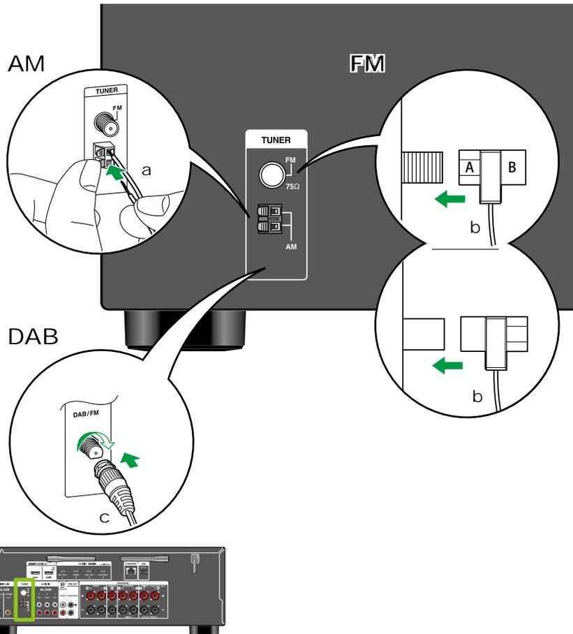
a Antenne cadre AM, b Antenne FM intérieure, c Antenne DAB/FM
