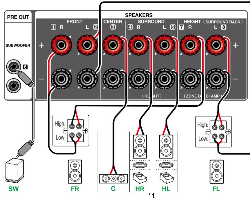
Assurez-vous de retirer le cavalier raccordant les prises des graves et les prises des aigus des enceintes qui prennent en charge la bi-amplification. Consultez également le mode d'emploi de vos enceintes.
