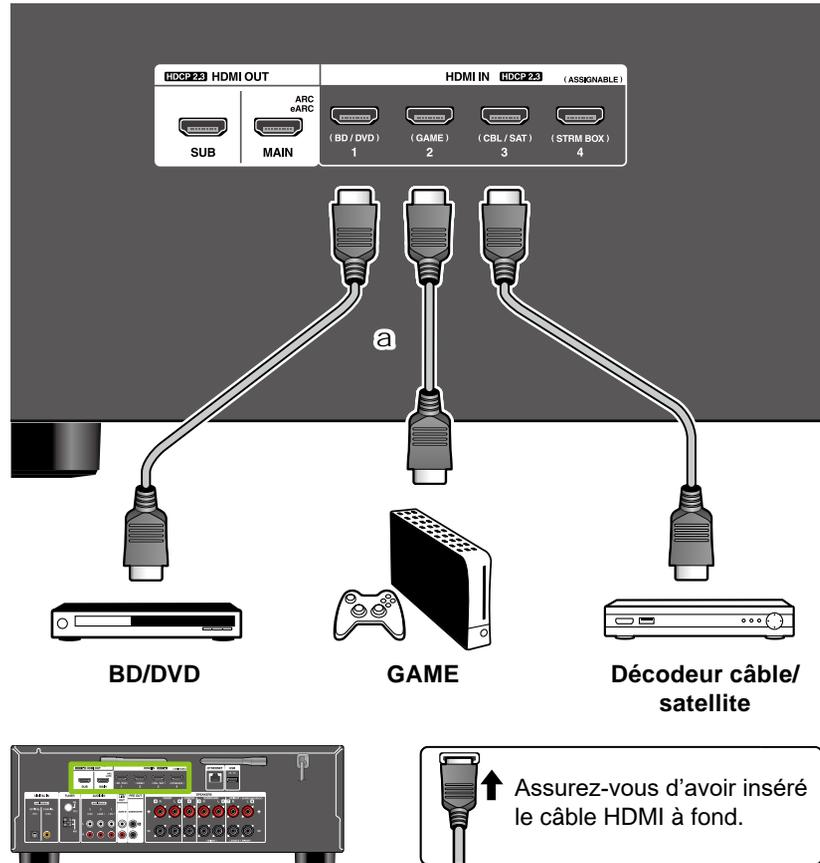
Il s'agit d'un exemple de raccordement avec un appareil AV possédant de prise HDMI. En raccordant un appareil AV conforme à la norme CEC (Consumer Electronics Control), vous pouvez utiliser la fonctionnalité HDMI CEC (\*) qui établit une liaison avec les sélecteurs d'entrée, etc. et la fonctionnalité HDMI Standby Through qui vous permet de transférer les signaux vidéo et audio provenant de l'appareil AV sur le téléviseur même si cet appareil est en veille.
