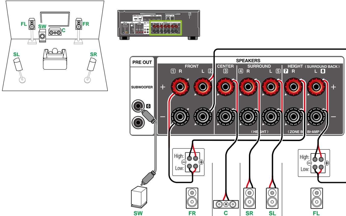
Assurez-vous de retirer le cavalier raccordant les prises des graves et les prises des aigus des enceintes qui prennent en charge la bi-amplification. Consultez également le mode d'emploi de vos enceintes.
