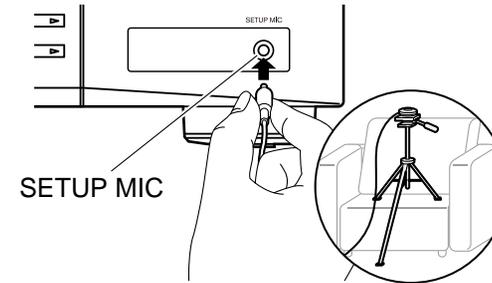
Pour installer un microphone de configuration d'enceinte sur un trépied, consultez l'illustration.
