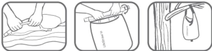
步骤2：将软管与储水袋出水口相连，确保红色排污阀保持关闭且蓝色洁净水出水口保持开启状态。可饮用的水将从蓝色洁净水出水口流出。
