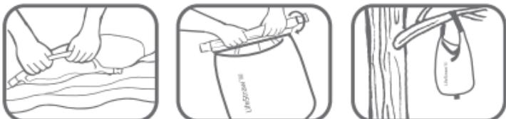
Étape 2 : Connectez le tuyau à la poche d'alimentation en eau et attendez quelques minutes que l'eau purifiée commence à sortir par le robinet bleu. Assurez-vous que le robinet rouge soit en position fermée (position horizontale) et que le robinet bleu soit ouvert (position verticale). Collectez l'eau potable depuis le robinet bleu.
