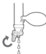
Schritt 3: Öffnen Sie das rote Schmutzwasserventil (vertikal) und leiten Sie das Schmutzwasser so ab, dass es nicht in Kontakt mit Trinkgefäßen, Besteck oder Menschen kommt.
