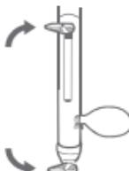
步骤1：确保储水袋中有水并关闭蓝色洁净水出水阀和红色排污阀。
