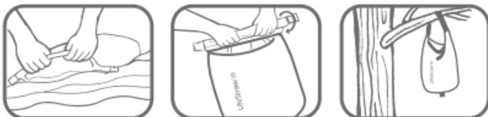
Schritt 2: Verbinden Sie den Schlauch mit dem Schmutzwasserbeutel und warten Sie ein paar Minuten, bis Reinwasser aus dem blauen Reinwasserventil fließt. Das rote Schmutzwasserventil muss geschlossen sein (horizontal), das blaue Reinwasserventil geöffnet (vertikal). Sammeln Sie das Reinwasser vom blauen Reinwasserventil.
